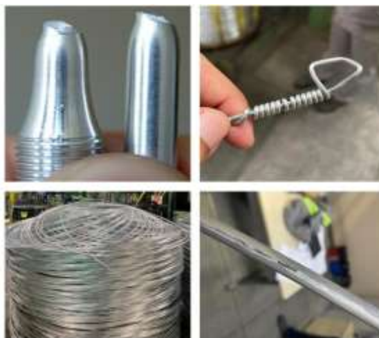
Figura 5 – Anomalias no processo de trefilação
