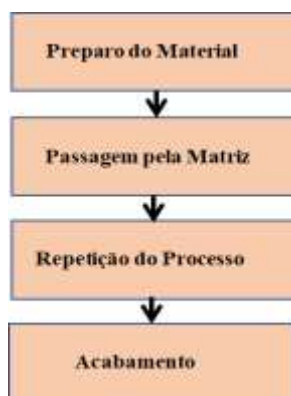
Figura 4 – Fluxo de produção da trefilação
