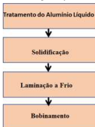
Figura 2 – Fluxo de produção da laminação
