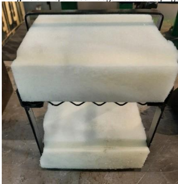
Figura 9 – Espuma de filtração do antirrespingo
