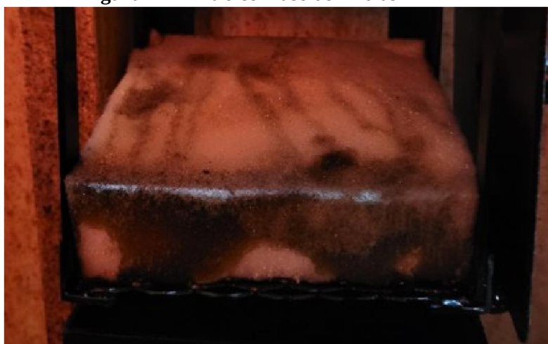
Figura 12 – Filtro com uso de 22 dias
