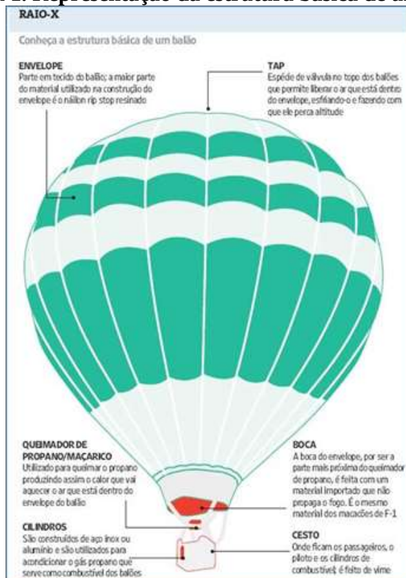
Figura 1. Representação da estrutura básica de um balão
