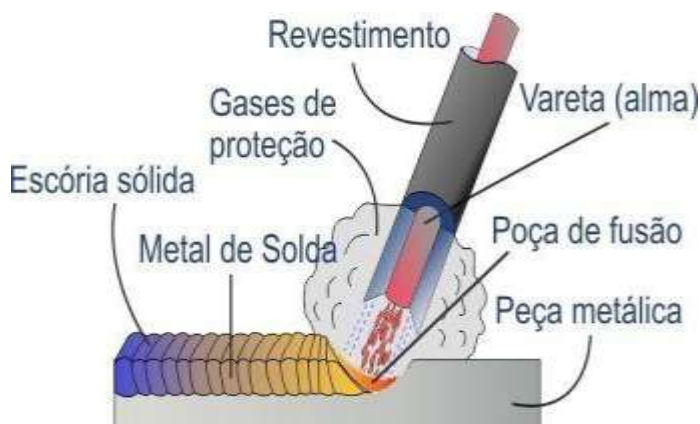
Figura 2: processo de soldagem eletrodo revestido
